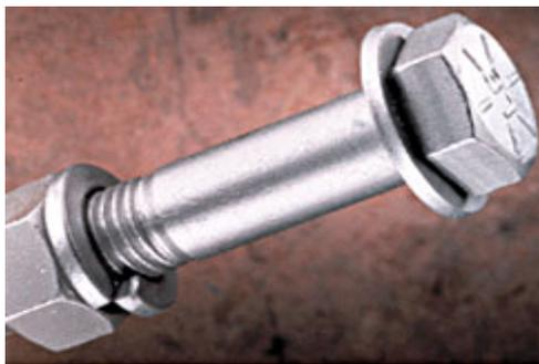
最小限の腐食性を持つ膜厚8ミクロンのめっきにASTM B117塩水噴霧を行った結果。:
